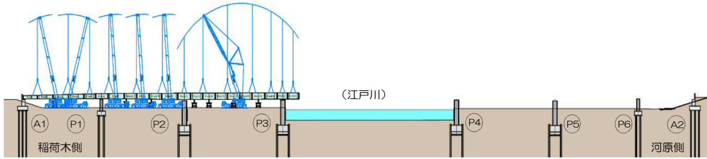
〈架設順序② 稲荷木側 [A1橋台～P3橋脚間] 桁架設 (送出し桁[P3橋脚～P4橋脚間])〉 H31.2月上旬～2月下旬
