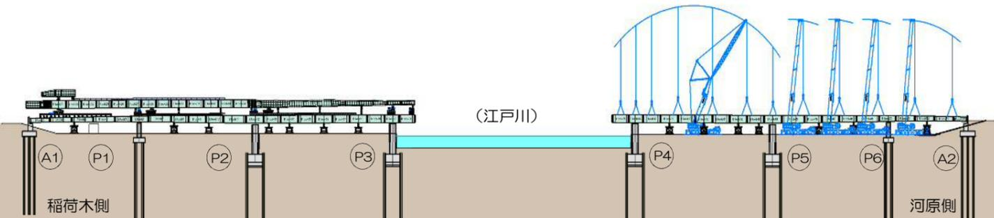
〈架設順序④ 稲荷木側 → 河原側 [P3橋脚～P4橋脚] 送出し架設〉 平成31.5月上旬～5月中旬
