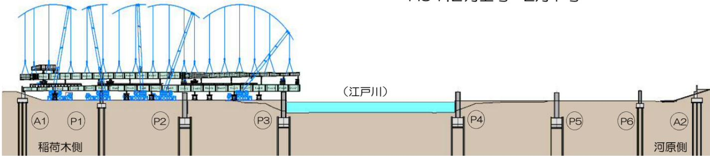
〈架設順序③ 河原側 [P4橋脚～A2橋台間] 桁架設〉 H31.3月中旬～4月上旬
